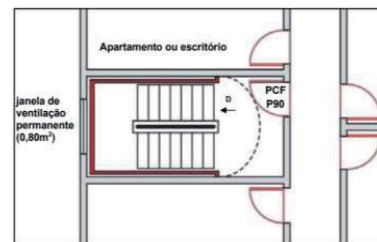
Figura 7 – Escada enclausurada protegida
